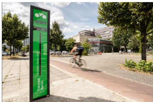
Abb. 71 Automatische Radverkehrs-Zählstelle (Bsp. Berlin) 25
