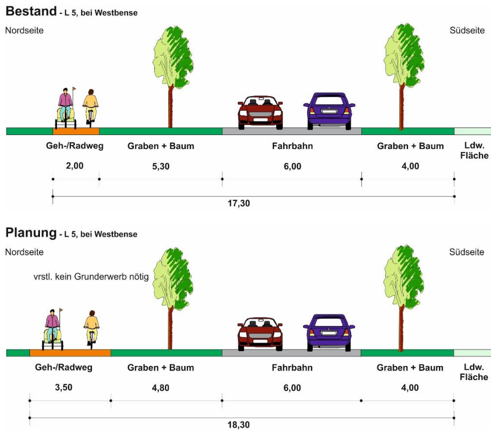
Abb. 49 Bestands- und Planungsquerschnitt L 5, bei Westbense
