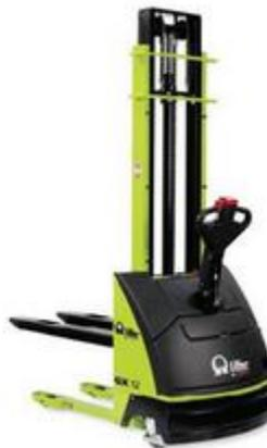
Außer zum Bewegen von Paletten kann der Stapler auch zum Transport von Behälterstapeln, zum Übereinanderstapeln von 1,1ern usw. eingesetzt werden. Ein „echter“ Gabelstapler ist deutlich teurer, ist aber dafür auf dem unregelmäßigen Untergrund deutlich im Vorteil. Ein Elektrohochhubwagen wäre für den Betrieb in der Halle ausreichend, aber weniger geeignet, im Freien eingesetzt zu werden; bei den unebenen Bodenverhältnissen ist dies nicht zu empfehlen.
